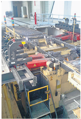
Impianto di riprofilatura tandem.
